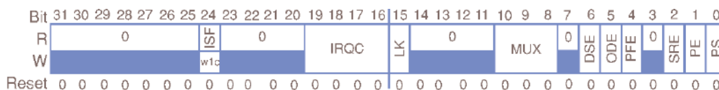
F14. Conexão do pino 42 ao GPIO PTA12 através do registrador PORTA PCR12.
