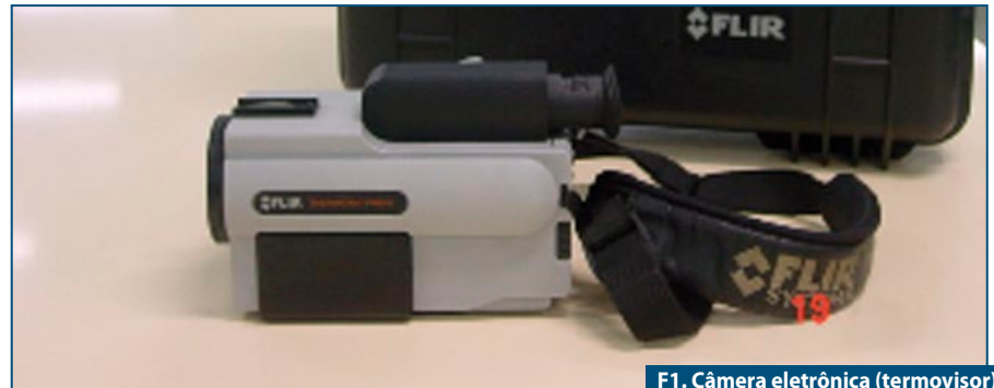
F1. Câmera eletrônica (termovisor) para radiação IV.
