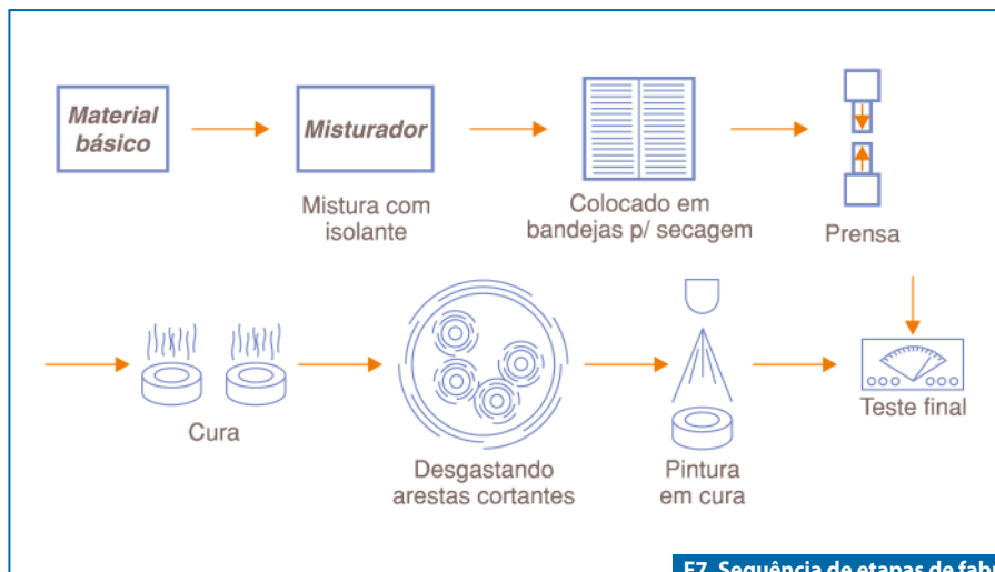
F7. Sequência de etapas de fabricação de núcleo de Fe m pó.
