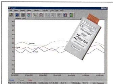
F4. Datalogger sem interface e com software de recuperação e análise do histórico.
