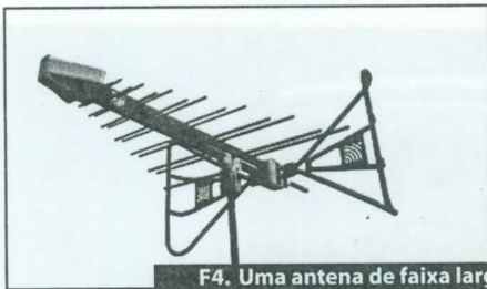
F4. Uma antena de faixa larga (80 MHz a 6 GHz) adequada para trabalhos e medição de campo.
