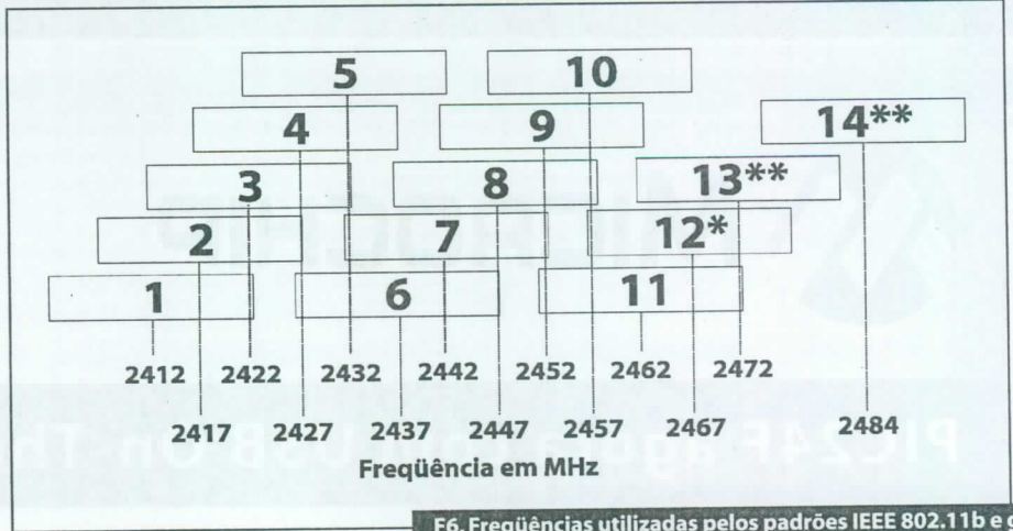
F6. Frequências utilizadas pelos padrões IEEE 802.11b e g. Note que elas estão dentro da faixa ISM de 2,4 GHz e apresentam sobreposição de canais. Cada canal apresenta uma largura de 22 MHz.
