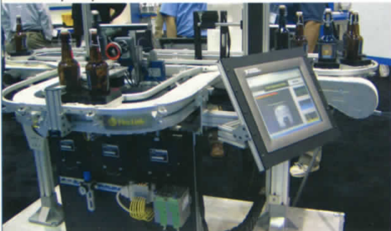
F3. Demonstração de inspeção visual de rótulos em linha de produção
