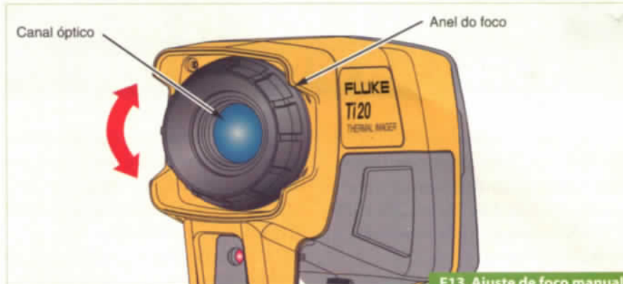
F13. Ajuste de foco manual.
