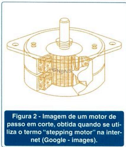
Figura 2 - Imagem de um motor de passo em corte, obtida quando se utiliza o termo “stepping motor” na internet (Google - images).
