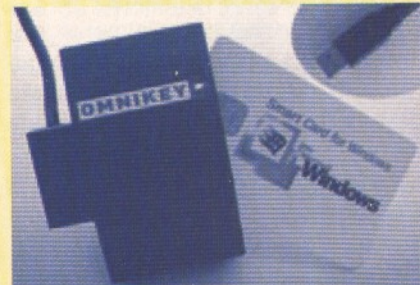
Figura 2 CardMan 2020, da OmniKey, para a leitura de Smart Cards com uma interface serial e baseado na tecnologia Infineon.
