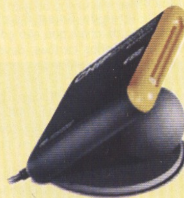
Figura 3 Chipdrive Extern 330 da TOWITOKO, leitor de Smart Card usando tecnologia Infineon.
