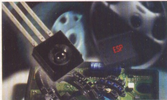
Sensor TE KS6400 da Vishay combina tecnologia CMOS com o padrão Photo-Schmitt-Trigger da empresa para maior desempenho em aplicações de sensoriamento e encoders".
