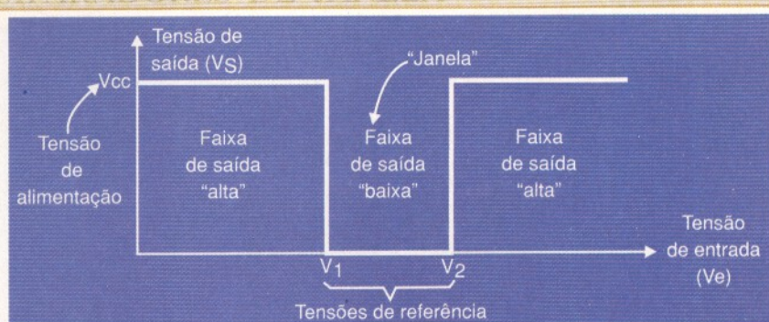
Figura 9 - A característica do comparador de janela.
