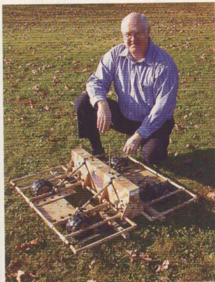
O "Mine Rover, desenvolvido no Laboratório de Física da Johns Hopkins University, proporciona uma barata e sofisticada forma de detecção de minas. Foto cortesia Johns Hopkins APL.
