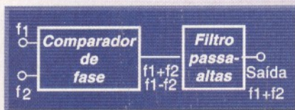
Fig. 14 - Um "Translator" usando PLL.
