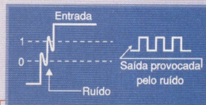
Fig. 7 - Ruídos na transição enganam o circuito.
