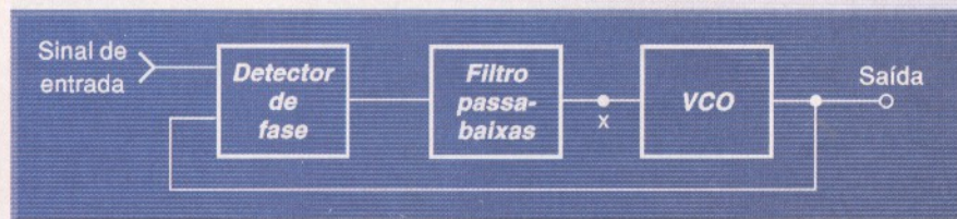
Fig. 1 - Diagrama de blocos de um PLL básico.
