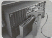
Fig. 55 - Um osciloscópio da série TDS3000 da Tektronix proporciona uma grande variedade de interfaces de comunicações, tais como porta Centronics Standard e módulos opcionais Ethernet RS-232, GPIB/RS-232 e VGA/RS-232.
