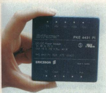
Fig. 36 - Conversor DC/DC Ericsson de 40 W.
