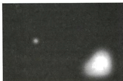
Fig. 1 - Efeito na imagem (pureza) devido à magnetização do cinescópio.
