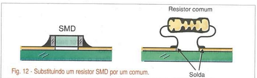
Fig. 12 - Substituindo um resistor SMD por um comum.
