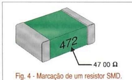
Fig. 4 - Marcação de um resistor SMD.
