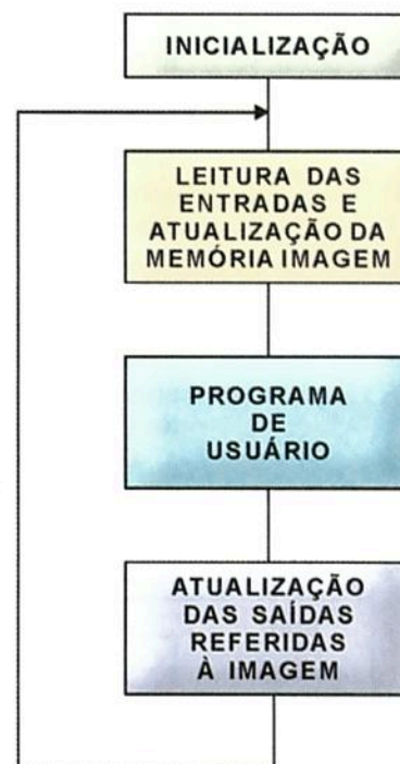
Fig. 5 - Representação do ciclo de varredura dos CLPs
