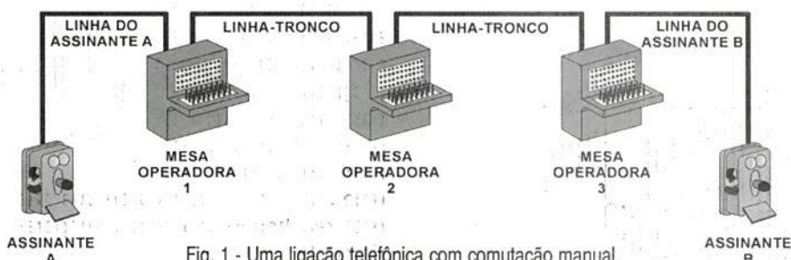
Fig. 1 - Uma ligação telefônica com comutação manual.
