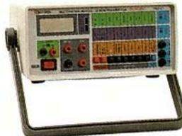
Tensão c.c. - 1000V, c.a. 750V resistores 20M $\Omega$ . Corrente DC, AC - 10A, hFE, diodos, apito, mede a tensão ZENER do diodo até 100V transistor no circuito.
