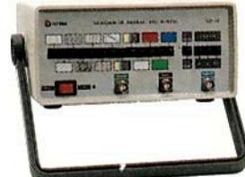
Gera padrões: círculo, pontos, quadrículas, círculo com quadrículas, linhas verticais, linhas horizontais, escala de cinzas, barras de cores, cores cortadas, vermelho, verde, azul, branco, fase. PALM/NTSC puros com cristal, saída de FI, saída de sincronismo, saída de RF canais 2 e 3.
