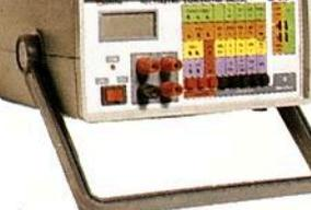
Tensão c.c. 1000V - precisão 0,5 %, tensão c.a. 750V, resistores 20 M $\Omega$ , corrente DC AC - 10A, ganho de transistores, hfe, diodos. Mede capacitores nas escalas 2n, 20n, 200n, 2000n, 20 $\mu$ F.
