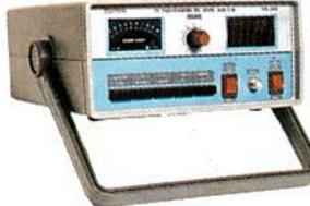
É o mais útil instrumento para pesquisa de defeitos em circuitos de som. Capta o som que pode ser de um amplificador, rádio AM - 455 KHz, FM - 10.7 MHz, TV/Videocassete - 4.5 MHz.....
