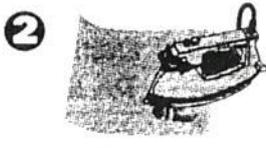
2 Transfira para a placa cobreada, usando um ferro de passar roupa.
