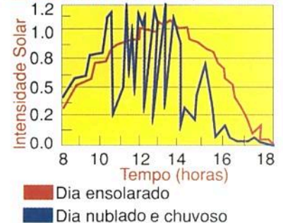
Fig. 13 - Gráfico da intensidade solar para um dia ensolarado e um chuvoso, na Austrália.
