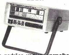
Gera padrões xadrez, vermelho, barras verticais e horizontais, quadrículas, pontos, R-Y B-Y, escala de cinza, branco, fase, círculo, 8 barras cores cortadas, cores completas, PAL M NTSC puros c/ cristal, saída RF 2-3-4.
