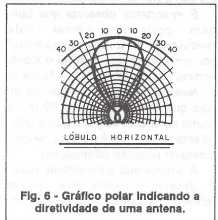
que indica o ponto em que o ganho cai 3 dB abaixo do máximo. Para o exemplo indicado isso ocorre quando nos desviamos 20 graus de cada lado da direção para a qual a antena está apontada. Isso significa que esta
