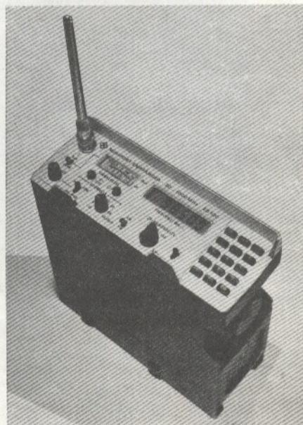
Receptor portátil para as faixas de VHF e UHF, cobrindo de 20 a 1000MHz
