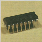
Circuito integrado XR2206 da EXAR
