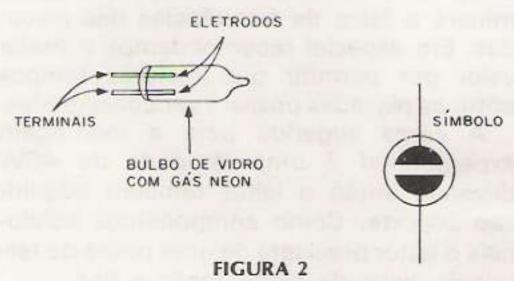
Se a tensão entre os eletrodos cair abaixo da tensão de manutenção da ionização, um pouco abaixo da tensão de ionização portanto, o gás volta a sua situação inicial e a lâmpada deixa de conduzir a corrente, apagando portanto.
