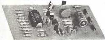
UM GERADOR DE SINAIS QUE DÁ ONDAS QUADRADAS E SENOIDAIS, NAS FREQUÊNCIAS DE 20HZ A 25KHZ, COM CONTROLES DE AMPLITUDE E FREQUÊNCIA.
