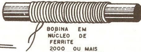
**BOBINA EM NÚCLEO DE FERRITE**
