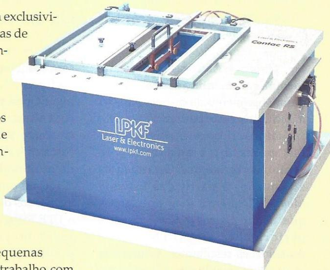
O controle dos sistemas Contac RS e MiniContac RS da LPKF é efetuado via conexão Ethernet e é programado para registrar automaticamente as informações do processo. Um sinal acústico indica o fim do processo.
