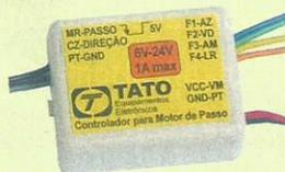
Permite controlar motores unipolares de até 24V e 1A por bobina.
