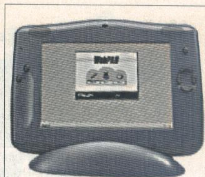
Fig. 3 - O WebPAD da National Semiconductor mede apenas 22 x 28 x 2,9 cm e pesa menos de 1,5 kg. Alimentado por baterias, ele se comunica com uma "estação base" em 2,4 GHz
