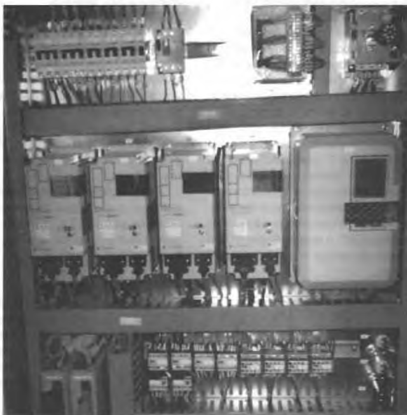
Conjunto de 5 inversores de frequência, utilizados em um centro de usinagem. O maior deles, à direita, aciona o eixo-árvore da máquina, e os outros 4 movimentam os eixos.
