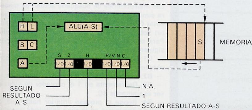
Las instrucciones **LDIR**, **LDDR**, **CPIR**, **CPDR** ejecutan cíclicamente su trabajo hasta que una determinada condición les indica que ha finalizado éste.
