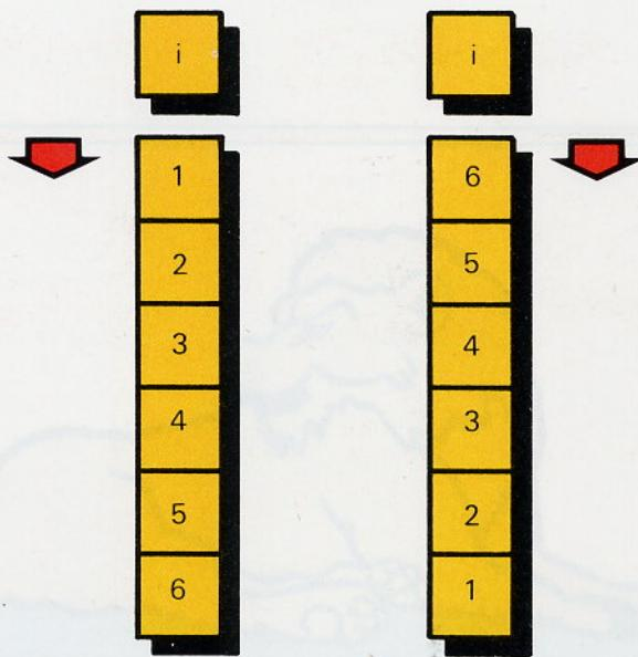
Con FOR ... TO ... DO la variable de control del bucle va aumentando en una unidad, con FOR ... DOWNTO ... DO disminuye en una unidad.
