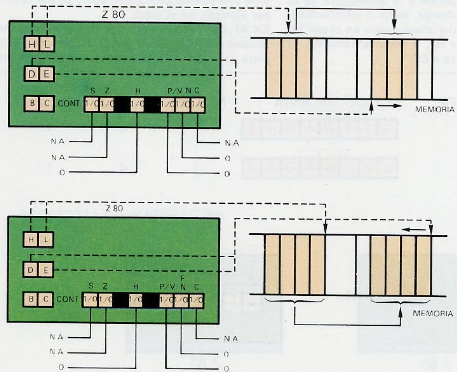
Cuando efectuemos la transferencia de un bloque, la dirección de origen de éste debemos cargarla previamente en el par HL, y la dirección de destino, en el par DE. Por su parte, los registros BC han de contener el número de bytes a ser transferidos.
