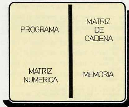
Este menú permite determinar qué clase de datos deseamos almacenar o recuperar del casete.
