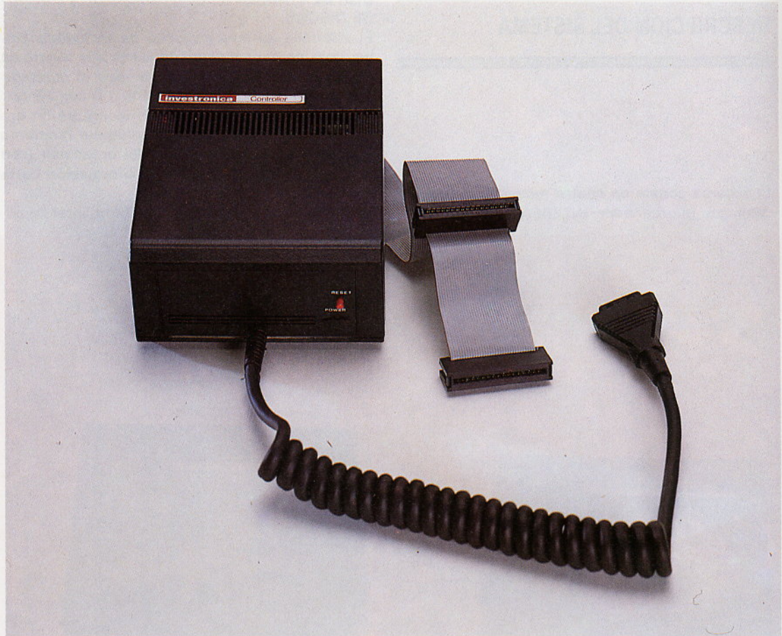
El CONTROLADOR posee su propio microprocesador Z-80 para tratar los datos procedentes del ordenador.
