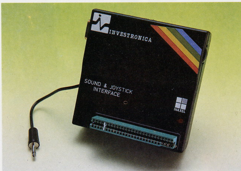
El SOUND & JOYSTICK INTERFACE de Investronica, proporciona además de un cómodo sistema de programación, un amplificador de sonido con volumen regulable.
