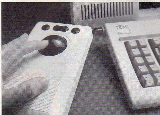
Platzprobleme auf dem PC-Arbeitsplatz ade. Mit Trackerball. Eine stationäre Einheit, die den Cursor mit einer x-y-gelagerten Kugel positioniert. Den Trackerball gibt's für:
