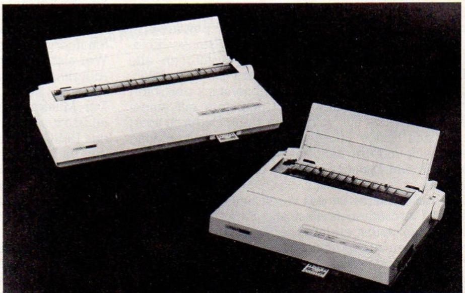
Mit den Matrixdruckern MSP-50 und dem MSP-55 rundet Citizen seine MSP-Produktpalette ab. Die beiden Drucker mit einer Druckbreite von 80 beziehungsweise 132 Zeichen bieten neben einer qualitativ hochwertigen Schrift, hohe Arbeitsgeschwindigkeit und die Möglichkeit des farbigen Drucks. Beide Drucker sind voll kompatibel zu den gängigen Mikrocomputersystemen. Die Garantie beträgt zwei Jahre.
