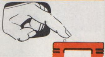
An der Rückseite der POWER CARTRIDGE befindet sich ein Reset-Taster. Durch einen Druck auf den Taster gelangen Sie in ein besonderes Menü. Diese Funktion, ausgelöst durch den Reset-Taster, klappt bei jedem Programm! Auf dem Bildschirm sehen Sie nun folgende Menüpunkte:
