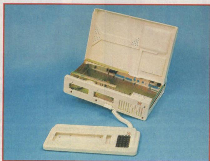
*Bild 3: Großes Gehäuse für zwei Laufwerke und abgesetztes Flachgehäuse für C64-Tastatur.*
