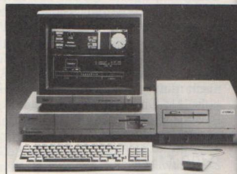
*Mit „Sidecar“ wird der Commodore Amiga kompatibel zum Industrie-Standard-Betriebssystem MS-DOS*
