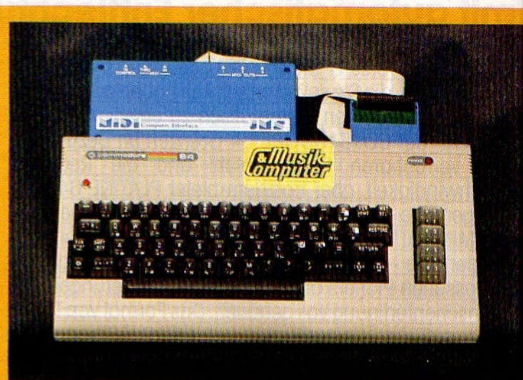
Komfortable MIDI-Version mit Flachbandkabel für Synthesizer-Netzwerkbildung
