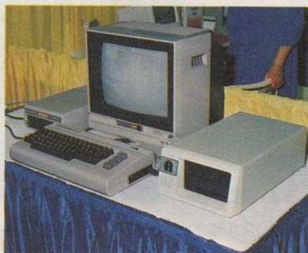
Die Lt. Kernel Harddisk wird über den Expansion-Port an den C 64 angeschlossen
