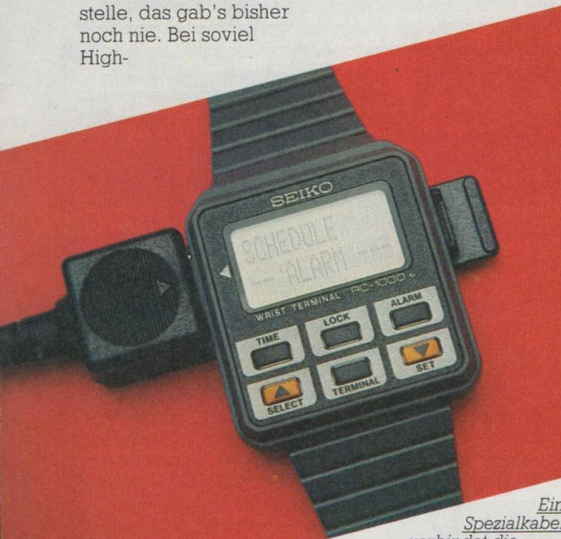
Ein Spezialkabel verbindet die Terminal-Uhr mit dem Computer
