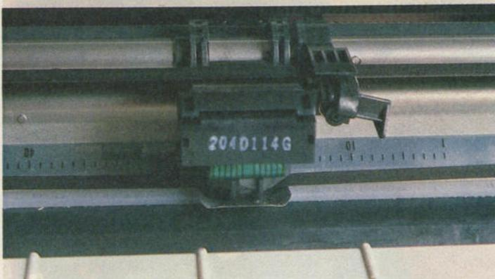
Ungewöhnlich: der senkrecht angebrachte Druckkopf zung problemlos über Friktionsräder transportiert. Die Papierabreißkante liegt sehr nahe am Druckkopf. Beim Abreißen wird kein Papier verschwendet.
