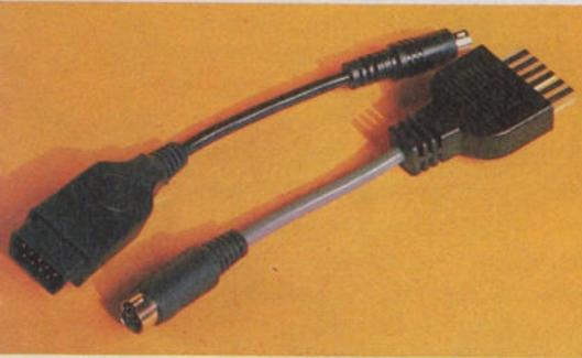
Adapter schließt die ganze Palette der Joysticks mit Atari-Steckern an die kleinen Commodore Computer an. Für Besitzer einer Datasette 1530 oder kompatibler Geräte gibt es ebenfalls einen Zwischenstecker, der den Rekorder an den C16 oder den C116 anpaßt. 19,50 Mark muß man pro Adapter ausgeben.
