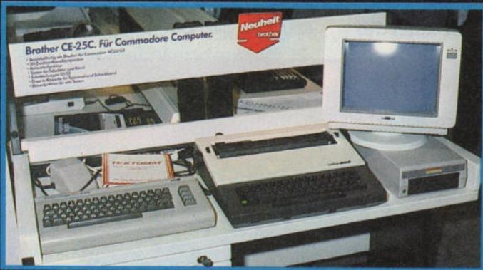
Die Schreibmaschine CE-25 C kann direkt an den Computer angeschlossen werden. Sie hat ein eingebautes Commodore-Interface.
