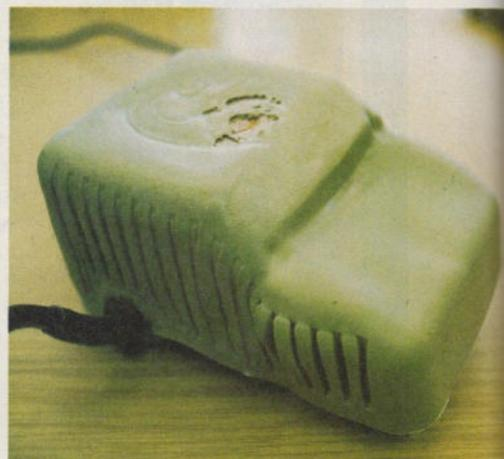
*Jede Hilfe kommt zu spät. Ein verschmorter Netztrafo nach Dauerbetrieb im Hitzestau.*
