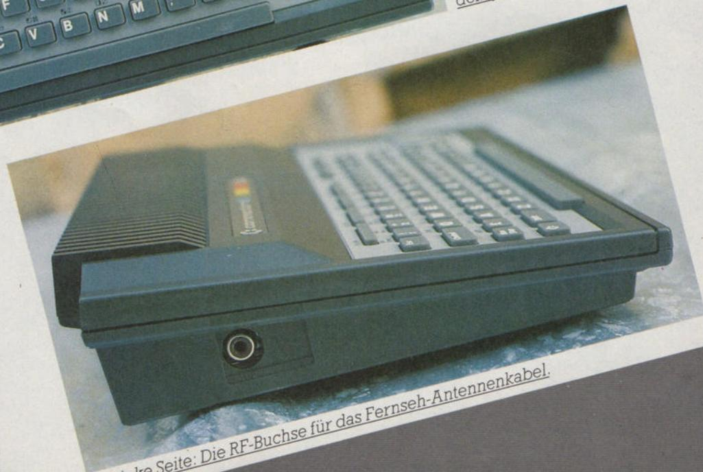
Linke Seite: Die RF-Buchse für das Fernseh-Antennenkabel.
