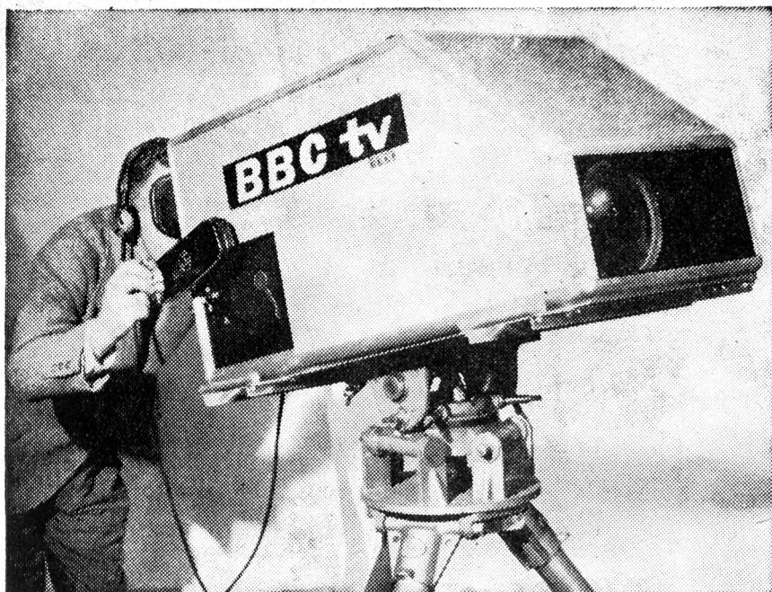
A PRIMEIRA CÂMARA ZOOM DE TELEVISÃO DO MUNDO — A primeira câmara zoom de televisão do mundo foi produzida pela Divisão de Engenharia da BBC em conjunto com uma das mais antigas firmas de ótica do Reino Unido. Capaz de extensa gama de focalização, a câmara pode passar instantaneamente de «close-ups» para vistas panorâmicas e vice-versa. (Foto BNS)
