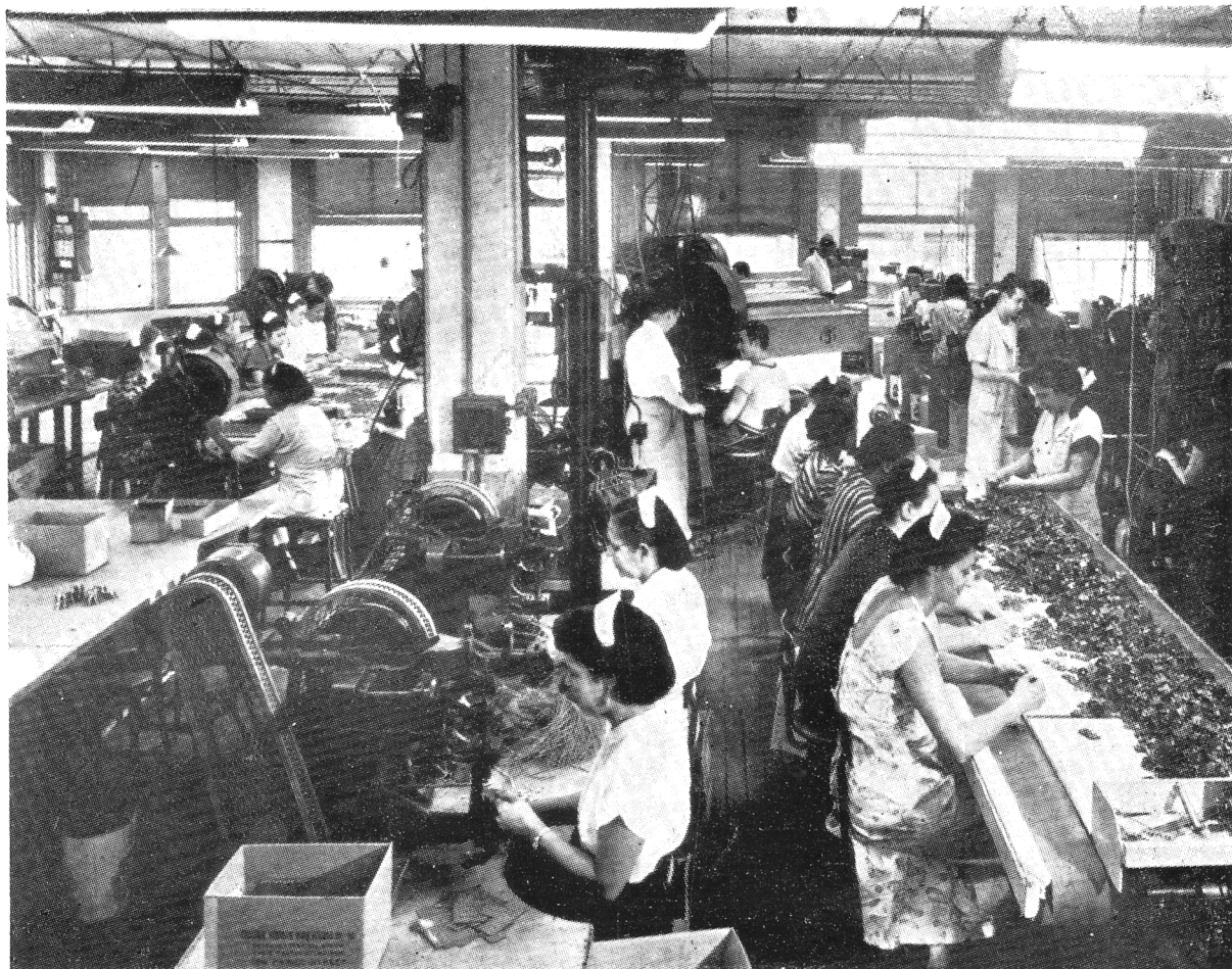
Fig. 5 — Uma vista geral de uma das secções onde os soquetes são inspecionados, afim de assegurar ao produto a máxima qualidade.
