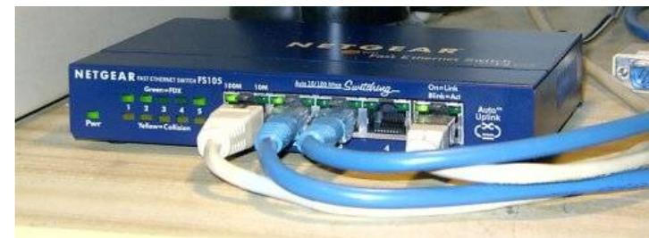
A diferença entre os hubs e switches é que o hub apenas retransmite tudo o que recebe para todos os micros conectados a ele, como se fosse um espelho. Isso significa que apenas um micro pode transmitir dados de cada vez e que todas as placas precisam operar na mesma velocidade, que é sempre nivelada por baixo. Caso você coloque um micro com uma placa de 10 megabits na rede, a rede toda passará a trabalhar a 10 megabits.
