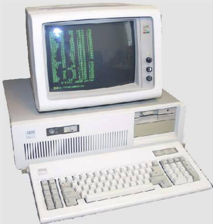
O PC AT vinha com um processador 286 de 6 MHz (depois surgiram versões mais rápidas, de 8, 12 e até 16 MHz), HD de 10 MB, monitor EGA (640x350, com 64 cores) e já usava disquetes de 5¼ de 1.2 MB. Como a memória RAM ainda era um item muito caro, existiam versões com de 256 a 2 MB de RAM.
