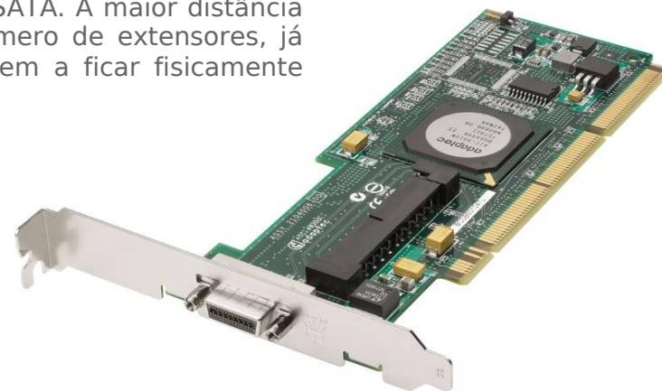
Assim como a maioria das controladoras SAS, esta Adaptec da foto utiliza um único conector SFF 8484, ao invés de 4 conectores separados. Ele simplifica um pouco a instalação, mas na prática não muda muita coisa, pois o conector dá origem aos 4 cabos separados da mesma forma:
