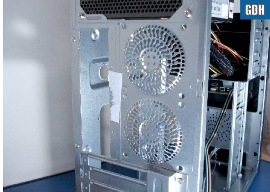
*A parte interna do gabinete possui um padrão de furação, destinado aos suportes e parafusos que prendem a placa mãe. Todos os parafusos necessários devem vir junto com o gabinete:*
