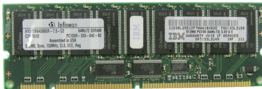
A desvantagem é que o uso dos registradores retarda a transmissão dos sinais, aumentando a latência e consequentemente reduzindo o desempenho dos módulos. A maioria das placas com suporte a módulos registered não suporta módulos unbuffered, de forma que seu uso não é uma opção. Também não é possível usar módulos registered, muito menos misturá-los com módulos unbuffered nas placas para desktop que não os suportam.
