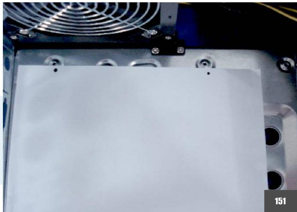
É importante apertar os parafusos de suporte usando uma chave torx, para que eles continuem no lugar depois de parafusar e desparafusar a placa mãe. Se não forem bem apertados, os parafusos de suporte acabam saindo junto com os usados para prender a placa mãe ao removê-la, o que não é muito agradável.
