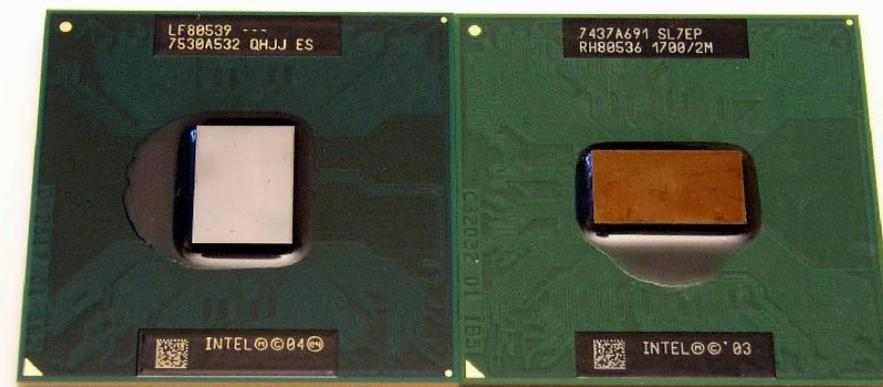
Core Duo baseado no core Yonah (à esquerda) e Pentium M com core Dothan
