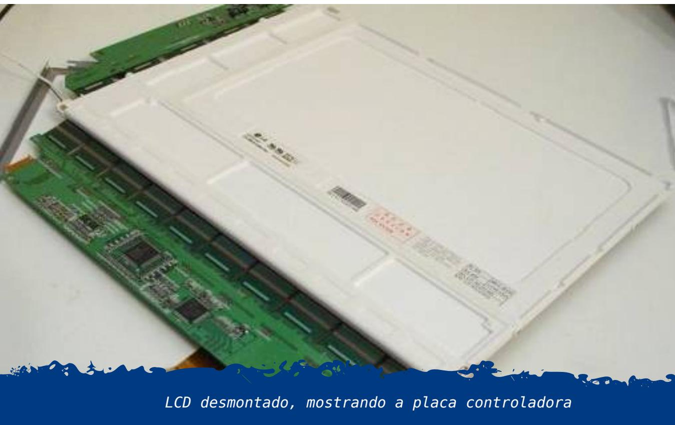
*LCD desmontado, mostrando a placa controladora*
