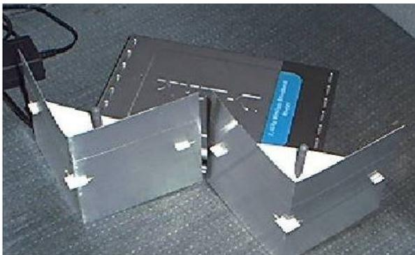
Assim como em uma antena parabólica, os sinais são refletidos pela folha metálica e concentrados em direção à antena do ponto de acesso, aumentando o ganho. Por outro lado, o sinal torna-se muito mais fraco nas outras direções, dificultando as coisas para seu vizinho interessado em roubar sinal. Apesar de primitivos, estes defletores podem proporcionar um ganho de até 12 dBi, um upgrade respeitável.
