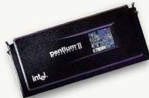
O Pentium II inclui 512 KB de cache L2, que opera à metade da frequência do processador (num Pentium II 400, por exemplo, o cache L2 opera a 200 MHz) e por isso é bem mais rápido que o cache usado nas placas soquete 7, que opera a apenas 66 ou 100 MHz. Com o cache movido para dentro do processador, as placas deixaram de trazer cache externo, o que continua até os dias de hoje. O único processador para micros PC a utilizar cache L3, foi o K6-3.
