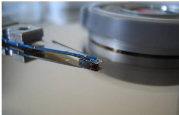
Os discos magnéticos são montados diretamente sobre o eixo do motor de rotação, sem o uso de correias ou qualquer coisa do gênero. É justamente este design simples que permite que os discos girem a uma velocidade tão grande.
