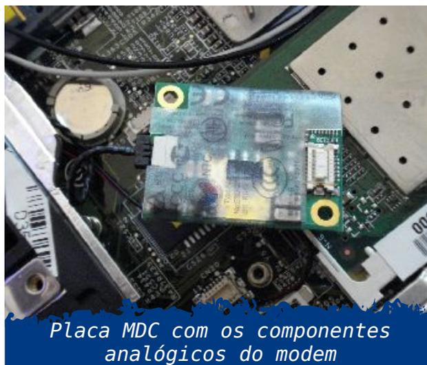
*Placa MDC com os componentes analógicos do modem*
