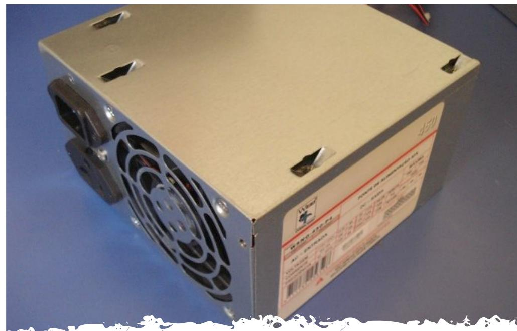
No teste de consumo, a fonte da Wise se saiu um pouco melhor que a da Clone com o sistema ocioso, mantendo o consumo total entre 103 e 104 watts (contra os 105/106 da Clone), mas ela acabou se revelando menos eficiente com o sistema em full-load, ficando entre 186 e 188 watts. No final ela acaba sendo a mais ineficiente das três.
