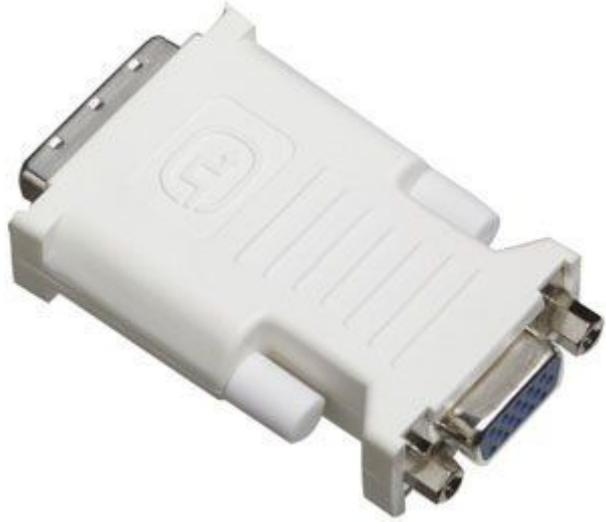
O conector DVI utiliza 29 pinos. Destes, os pinos 8, C1, C2, C3, C4 e C5 são usados para transmitir o sinal analógico usado pelos monitores antigos, enquanto os demais transmitem o sinal digital, como você pode ver no diagrama:
