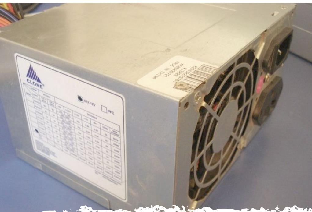
O consumo com o sistema ocioso oscilou entre 105 e 106 watts e ficou entre 180 e 182 com ele em full-load. Como disse, o consumo real do micro é de cerca de 75 watts quando ocioso e cerca de 125 watts quando em full-load. O resto é energia desperdiçada pela fonte, sobretudo na forma de calor.
