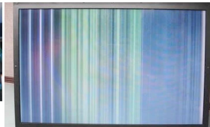
Você pode diferenciar os defeitos no LCD de defeitos causados pela memória ou defeitos no controlador de vídeo (que faz parte da placa-mãe) usando um monitor externo. Na maioria dos notebooks, você precisa pressionar uma combinação de teclas, como Fn+F4, Fn+F5, Fn+F7 ou Fn+F8, para ativar o monitor externo. Se a imagem aparece corrompida no LCD, mas fica perfeita no monitor externo, então o problema é ou nos cabos ou no próprio LCD.
