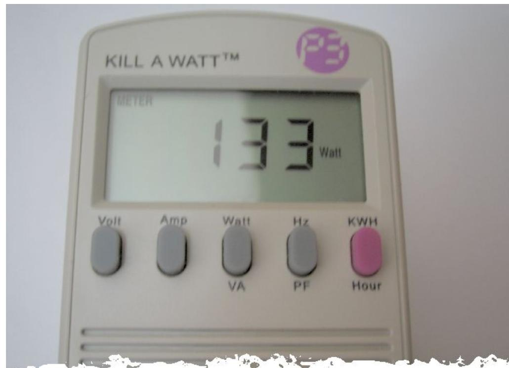
Ele é interessante para medir o consumo global do micro e fazer testes de consumo, analisando a redução ao reduzir o clock do processador, ativar recursos de gerenciamento de energia, verificar a economia real ao trocar a fonte ou outro componente, medir a perda causada pelo uso do nobreak e assim por diante.
