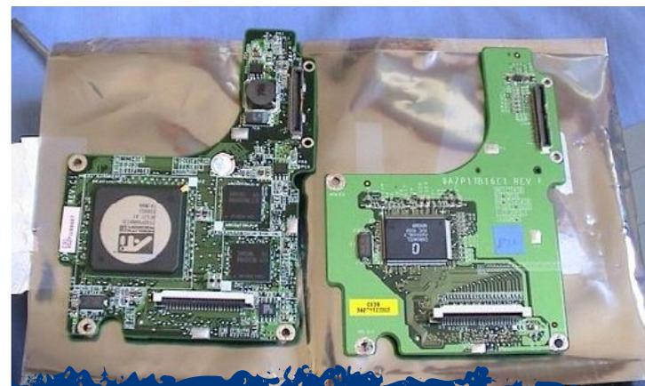
*Placa proprietária usada em um Acer Aspire 1350 (à esquerda) e uma placa alternativa para o mesmo modelo, baseada em um chipset diferente*
