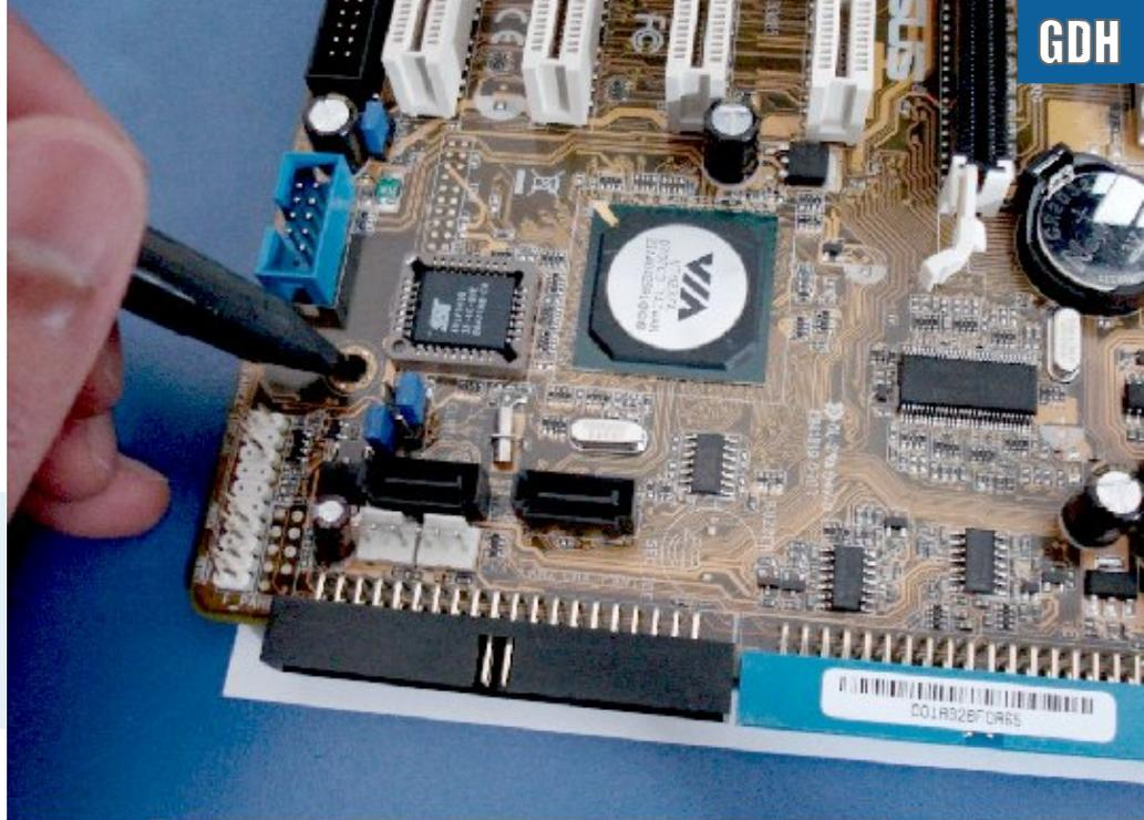
*O conjunto com os parafusos e espaçadores necessários deve vir junto com o gabinete. Ele é chamado de "kit de montagem" pelos fabricantes. Normalmente o gabinete vem também com o cabo de força, com exceção dos modelos sem fonte, onde o cabo vem junto com a fonte avulsa.*
