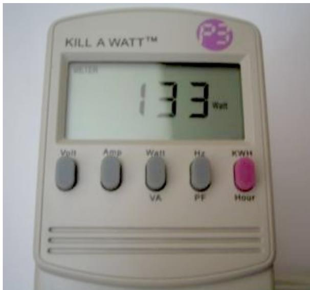
Ele é interessante para medir o consumo global do micro e fazer testes de consumo, analisando a redução ao reduzir o clock do processador, ativar recursos de gerenciamento de energia, verificar a economia real ao trocar a fonte ou outro componente, medir a perda causada pelo uso do nobreak e assim por diante.
