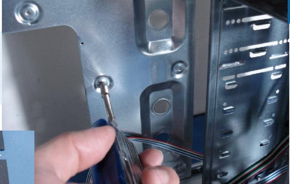
Antes de instalar a placa mãe, você pode aproveitar para encaixar os conectores do painel frontal do gabinete e das portas USB frontais, que são muito mais fáceis de encaixar com a placa mãe ainda sobre a mesa, do que com ela já instalada dentro do espaço apertado do gabinete, com pouca luz.
