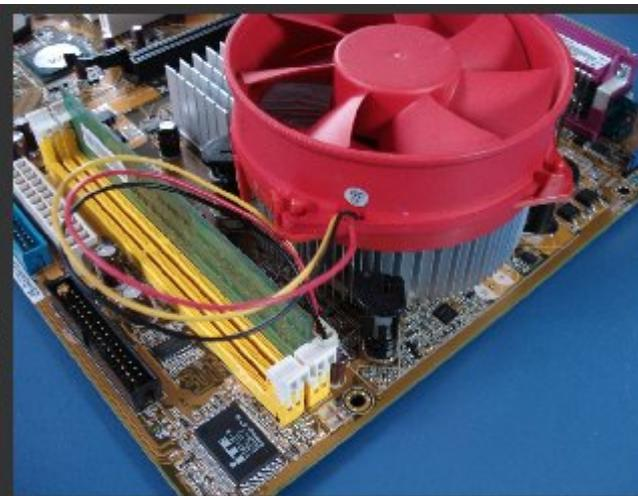
Ao instalar o cooler, você só precisa deixar as presilhas na posição de instalação e pressioná-la em direção a placa. Ao contrário dos coolers para placas soquete 754, 939 e AM2, você pode encaixar o cooler em qualquer sentido.
