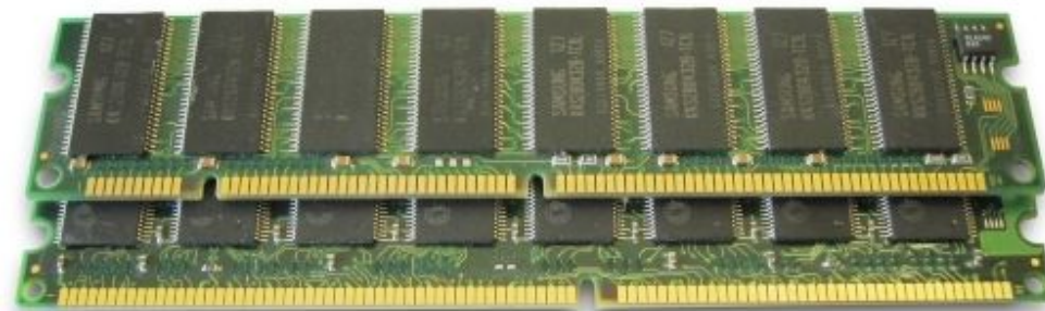
Diferença no chanfro da memória SDR e DDR
