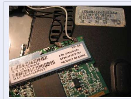
Terminando, falta apenas encaixar a placa no slot (algumas são um pouco difíceis de encaixar), fechar o note e testar.
