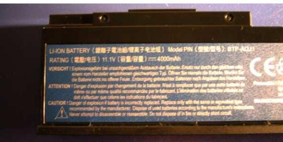
Se temos 4000 mAh (micro Amperes-hora) a 11.1V, significa que a bateria fornece um total de aproximadamente 44.4 watts/hora de energia.
