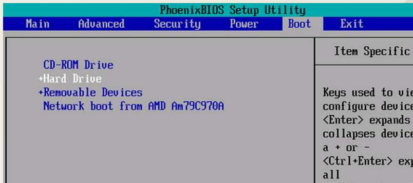
Ao reiniciar o micro sem o CD no drive, ele volta a carregar o Windows ou outro sistema que estiver instalado no HD. Esta alteração apenas faz com que ele passe a procurar primeiro no CD-ROM.
