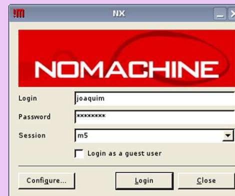
Por padrão, o servidor NX é inicializado automaticamente durante o boot, junto com o servidor SSH. Caso queira desativá-lo temporariamente, use o comando `"/usr/NX/bin/nxserver --stop"` e, para inicializá-lo novamente, use o `"/usr/NX/bin/nxserver --start"`.
