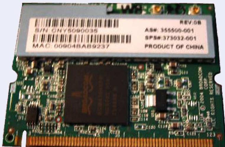
Não se engane pelas fotos. As placas mini-pci são muito pequenas, quase do tamanho de uma caixa de fósforos e os conectores a antena são quase do tamanho de uma cabeça de alfinete. Eles são frágeis, por isso é preciso ter cuidado ao plugá-los na placa. O fio branco vai sempre no conector no canto da placa e o preto no conector mais ao centro, como na foto:
