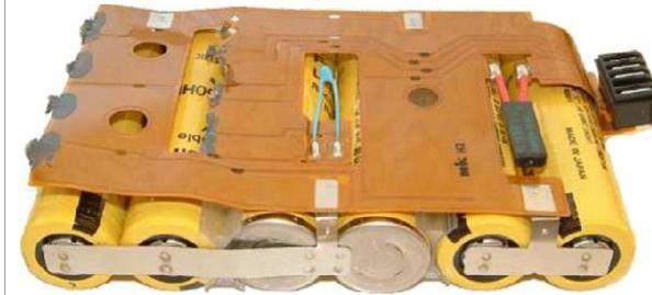
Em geral, o "circuito inteligente" não é tão inteligente assim, pois se limita a monitorar a tensão fornecida pela bateria. Para evitar explosões acidentais, os fabricantes precisam trabalhar dentro de uma margem de tolerância, de forma que normalmente é usada apenas 80 a 90% da capacidade real da bateria.
