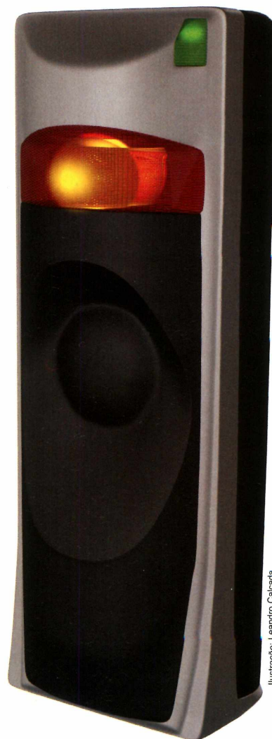
O teclado virtual se resume a uma torre que emite raios laser
