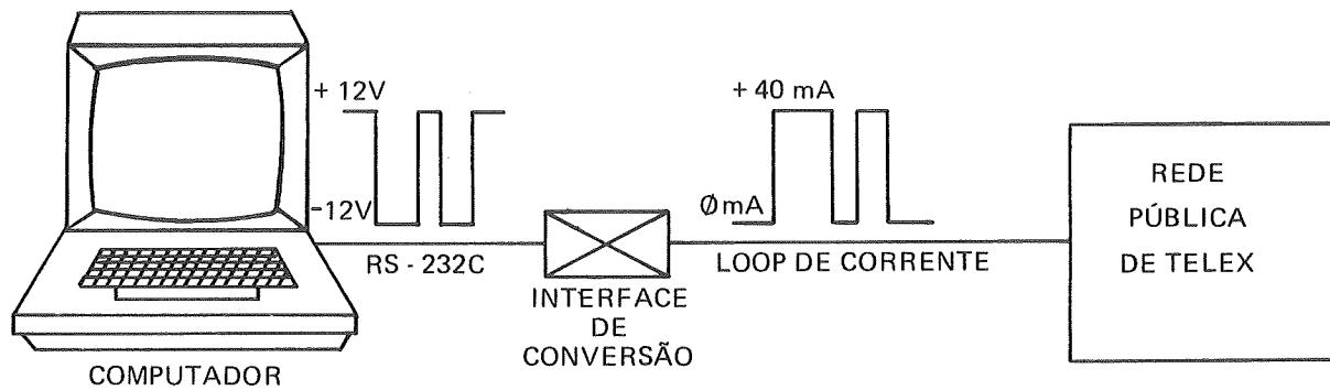
Figura 1 – Ligação de uma porta de I/O RS-232C à rede pública de telex
