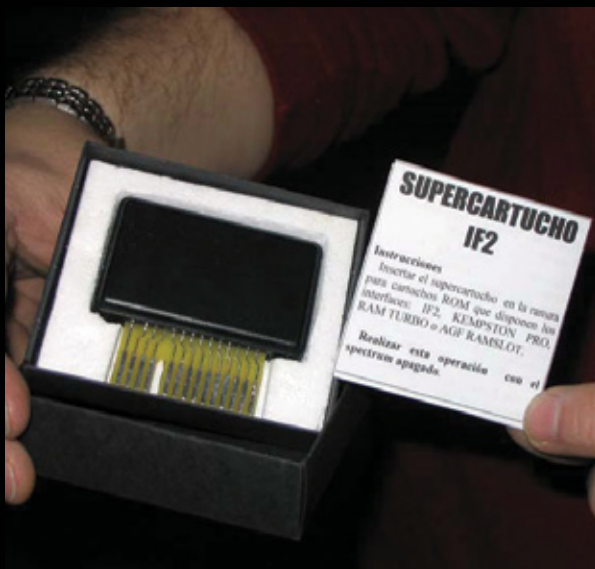
🐛 Los 'manitas' de la escena. José Leandro Novellón es un entusiasta de la electrónica y del Spectrum que, además de documentar dispositivos en su página http://hardware.speccy.org , realiza diseños propios como este Supercartucho IF2, que puede contener hasta 15 juegos de 16 KB.
