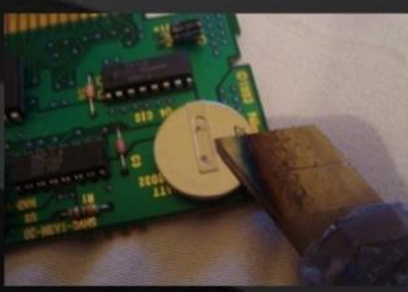
Retirando a solda
