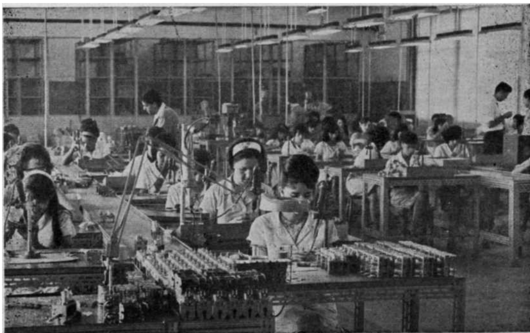
Aspecto parcial da linha de montagem dos seletores do canais Stevenson.
