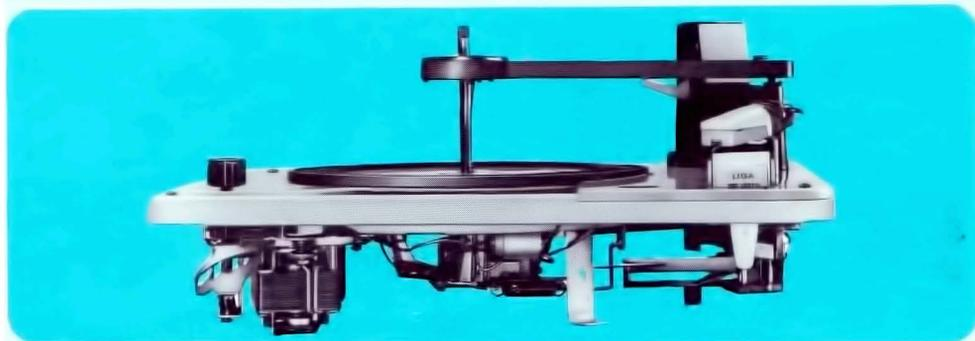
**funcionamento manual** • Além de suas funções totalmente automáticas, o mecanismo do cambiador permite também operação manual. O braço do fonocaptor pode ser levado manualmente do seu suporte de descanso até o disco, ligando automaticamente o motor. Colocando o compressor sobre o pino central, o cambiador será desligado automaticamente após terminar a reprodução do disco. O braço volta à sua posição inicial e desliga o cambiador.
