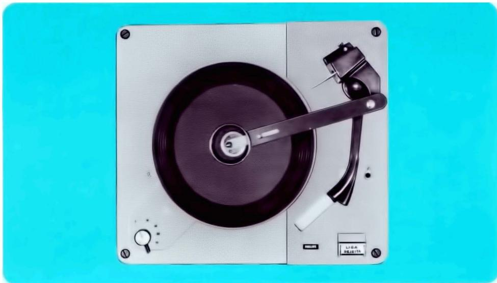
**prato** • Fundido em metal extrapesado; torneado e dinamicamente balanceado. O eixo é de aço inoxidável, apoiado sobre esferas de aço dentro de um anel de nylon, o que proporciona o mínimo de atrito com baixíssimo nível de ruído (rumble). A precisão da montagem deste prato permite reduzir a flutuação de velocidade de rotação (wow & flutter) para um valor abaixo de 0,3% r.m.s.
